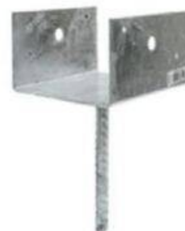
SIMPSON STRONG-TIE MD/® Étrier de poteau galvanisé Utilisé pour connecter les poteaux aux bases en béton. Acier de calibre 13 avec une tige d'armature de 15 mm x 7". Galvanized post saddle bracket Used for connecting posts to concrete footings. 13 gauge steel with 15 mm x 7" rebar. 6" x 6". 2649-511 11,49
